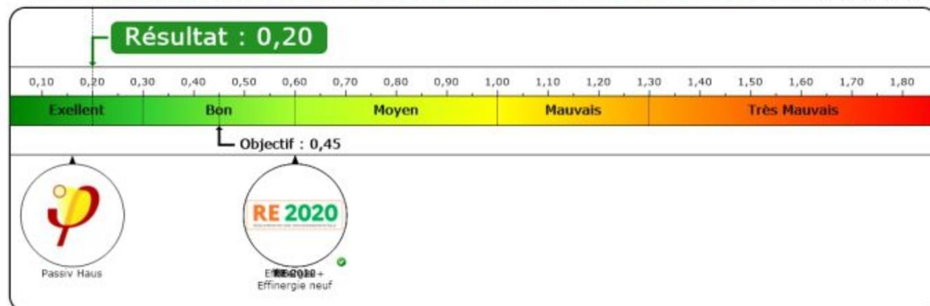
**Q4Pa-surf [m<sup>3</sup>/(h.m<sup>2</sup>) conforme à l'objectif donné**
